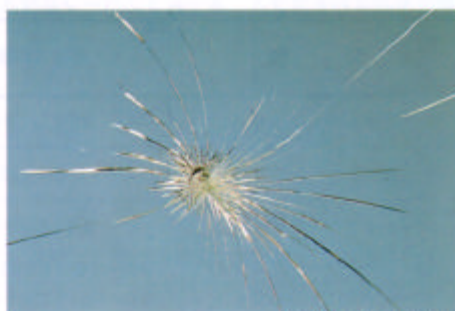
合わせガラスの破損状況
